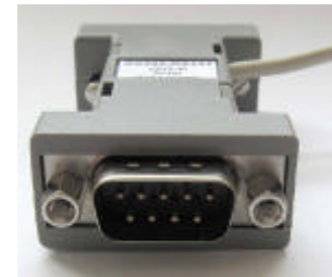
UNC Gewindebolzen an der PC-abgewandten Seite
